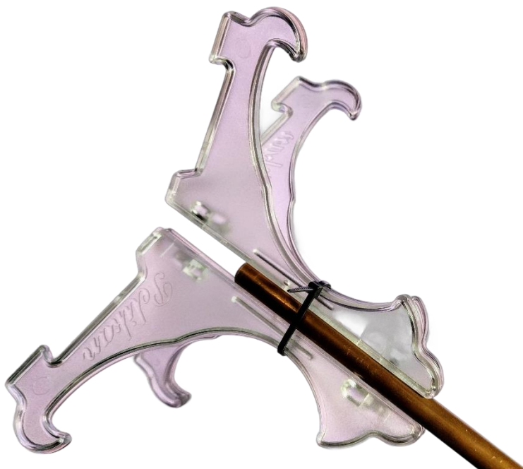
شکل ۲) نحوه اتصال لوله مسی به پایه‌های پلاستیکی
